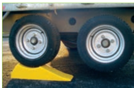
1 - Changer une roue crevée sans décharger
