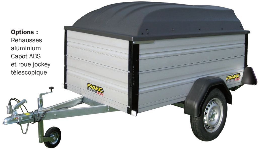
Ridelles alu avant et arrière totalement amovibles.
