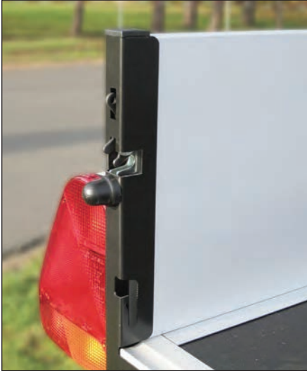
Ouverture rapide des ridelles à l'avant et à l'arrière (système automobile).
