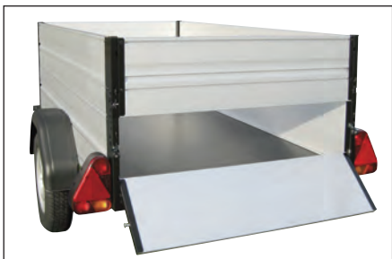
Possibilité d'ouverture de la ridelle arrière avec la rehausse alu.
