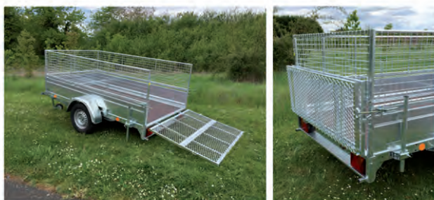
RE250 F130 avec rehausse grillagée de 50 cm, béquilles de stabilité arrière et rampe pliante 1,10 m galvanisée à chaud
